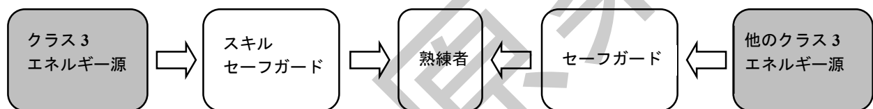
図 19—クラス 3 エネルギー源に対する機器のサービス状態における熟練者の保護モデル
